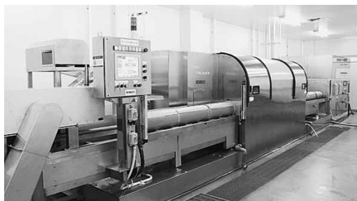
図6 FOOD FRESHERの外観（400MPa、処理容積100リットル） Fig. 6 FOOD FRESHER (400MPa, 100 liters of process volume)
