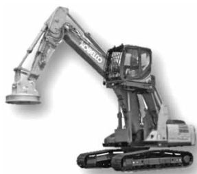
図11 新型マグネット仕様機の外観
