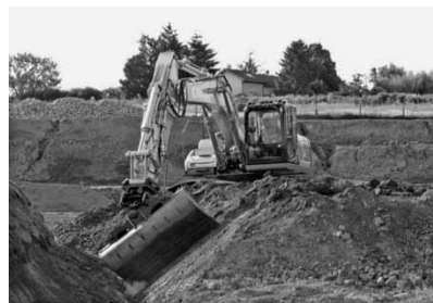
図9 チルトバケットを搭載したSK200H-10の外観
