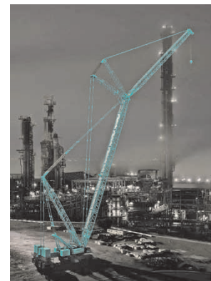
図3 SL16000J-H超大型クローラークレーン Fig. 3 Super-large lattice boom crawler crane, SL16000J-H
