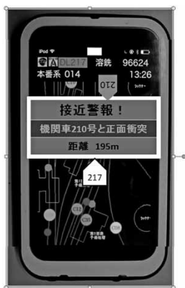
図10 携帯端末に表示される警告例 Fig.10 Warning message displayed on handy terminal
