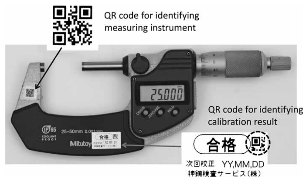
図2 外側マイクロメータとその校正結果を管理するための2種類のQRコード
