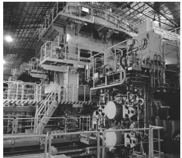
図3 加古川製鉄所第2分塊工場の鋼片圧延機 Fig. 3 Rolling mill in No. 2 blooming mill factory at Kakogawa Works
