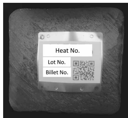
図7 鋼片に貼付したQRコード耐熱タグ Fig. 7 Heat-resistant tag with QR code on billet
