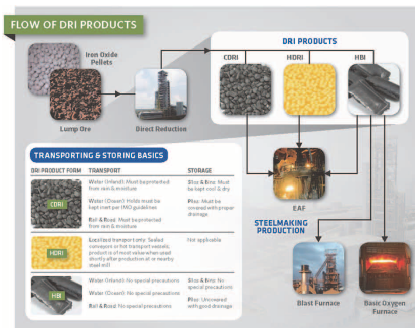
図2 各種DRI製品の特徴とその用途 Fig.2 Description and use of DRI products
