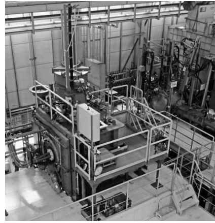
図7 パイロット規模のCCIM炉外観 Fig.7 Appearance of pilot-scale CCIM furnace
