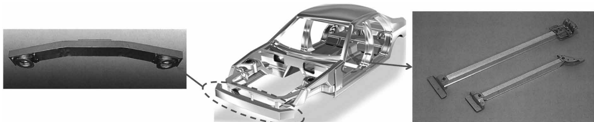
図1 バンパーレインフォースおよびドアビーム Fig.1 Bumper reinforcement and door beam
