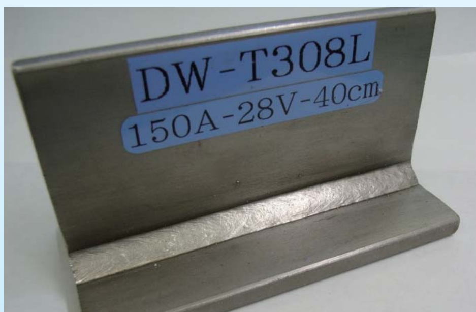
DW-T308L 在图示标签的条件下的焊道外观。
