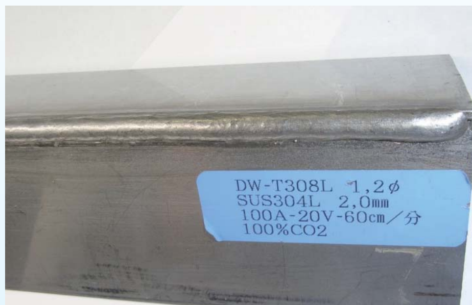
DW-T308L \phi 1.2mm 在图示标签的条件下的焊道外观。
