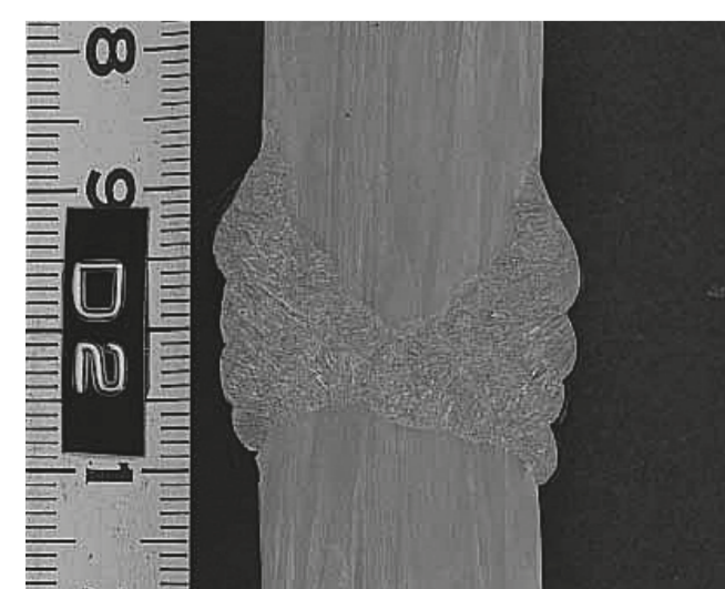
Wire : PREMIARC DW-2209 Base metal : S31803 (20t) Welding position : Horizontal (2G)
