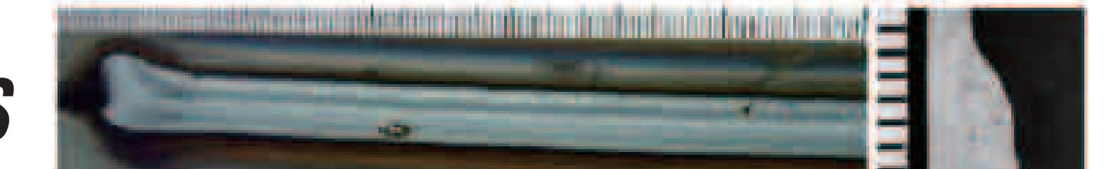
パルスMAG溶接, 320A-28V, 150cm/min SPCC 2.9t
