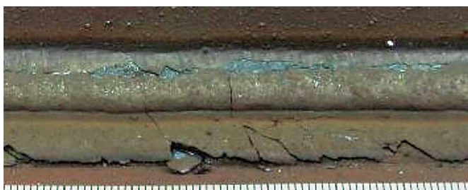
従来すみ肉ワイヤ (※3パス溶接後のスラグ包被状態)
