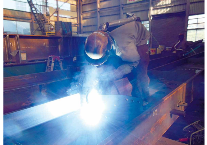
梁の水平すみ肉溶接
