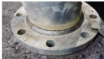
水平すみ肉溶接(1層)240A、棒径5.0mmφ
