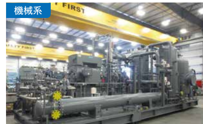
機械系 スクリュ式非汎用圧縮機 世界トップレベルのシェア 1956年に国内で初めてスクリュ式圧縮機を製造して以降、大型プラント向けなどに納入
