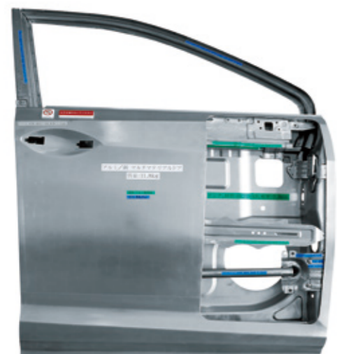
当社グループが独自開発したマルチマテリアルドア構造（試作品）
