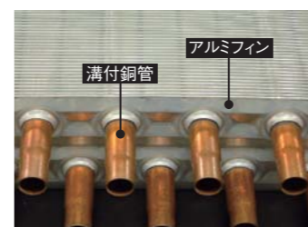
エアコン用熱交換器のカットサンプル
