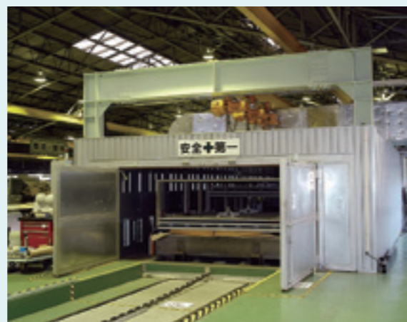
▲熱精算結果に基づき電力使用量を半減したアルミニウム電気炉
