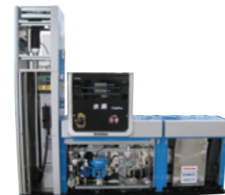
*拡散接合：母材を密着させ、母材の融点以下の温度条件で、塑性変形をできるだけ生じない程度に加圧して、接合面間に生じる原子の拡散を利用して接合する方法。(JIS Z3001 溶接用語より抜粋)
