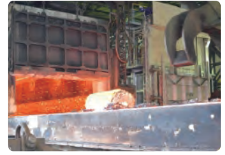
▲ 熱診断による省エネルギー活動中の高砂製作所・鑄鍛鋼工場鍛圧加熱炉
