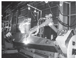
V型50度坡口、多层堆焊3道焊接
