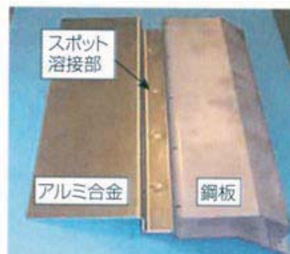
アルミ合金-鋼溶接例
