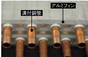
エアコン用熱交換器のカットサンプル
