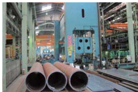
東京スカイツリーに納入した円形鋼管と同型の鋼管
