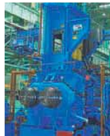
バッチ混練機「BBミキサー」
