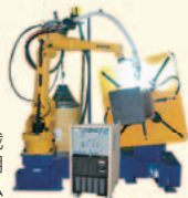
REGARCTM搭載 省スペース型鉄骨コア・仕口兼用 溶接システム
