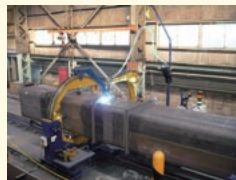
柱大組立溶接ロボットシステム
