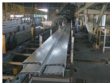
鉄道車両に使用されるアルミ押出型材
