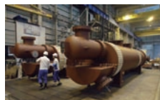
マルタ島LNG受入基地向けLNG気化器
