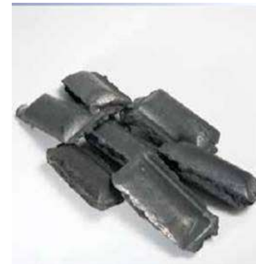
HBI (Hot Briquetted Iron) 海上輸送等を目的に DRIを固形化させたもの
