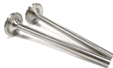
図. 試作エンジンバルブの外観 (切削加工によって模擬形状に仕上げたもの)
