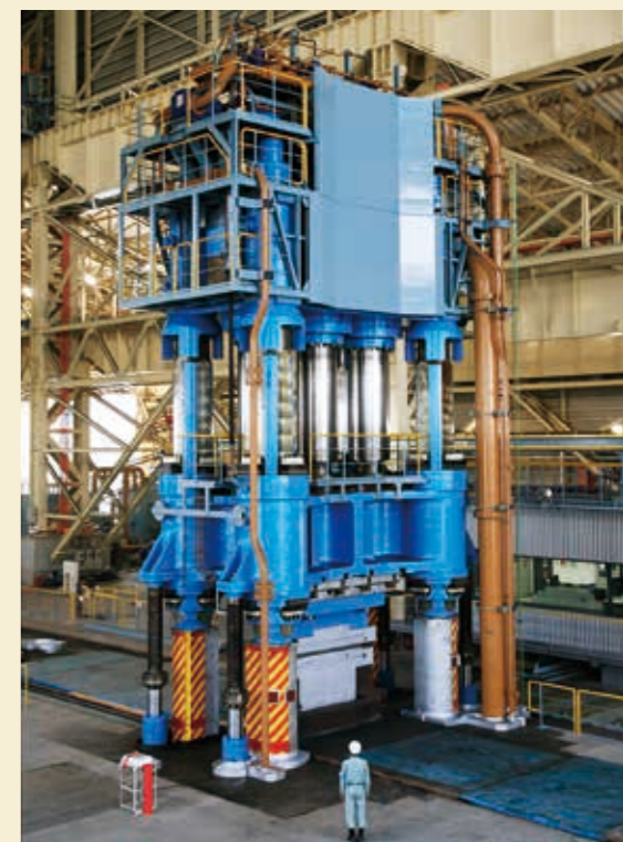
▼ 10,000トン鍛造プレス 10,000 ton Hydraulic Forging Press
