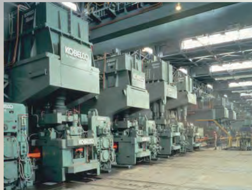
▲粗列圧延機 溝を付けたロールの中に熱鋼を通し、断面積を小さくします。
