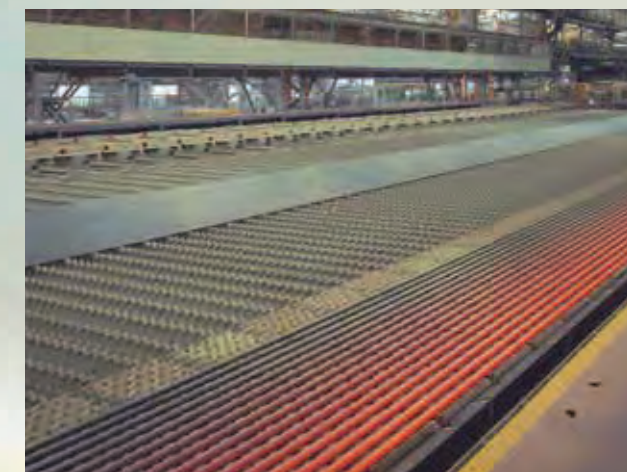
▲棒鋼冷却床 全長にわたり均一に冷却することで、「曲がり」を最小限に抑えます。
