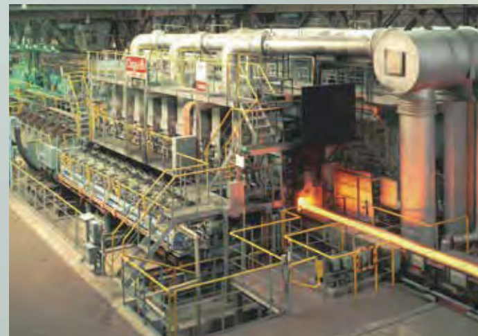
▲加熱炉 ビレットを約1,000℃に加熱します。
