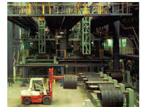
線材コイル自動酸洗被膜設備
