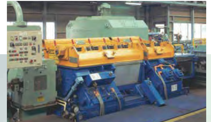
▼仕上圧延機(サイジングミル) 低温圧延が可能な高剛性の圧延機です。真円度の高い寸法精度で仕上げる ことができます。(制御圧延・寸法制御)
