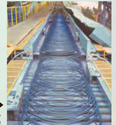
▲製品水冷帯 圧延温度をコントロールします。(制御圧延)
