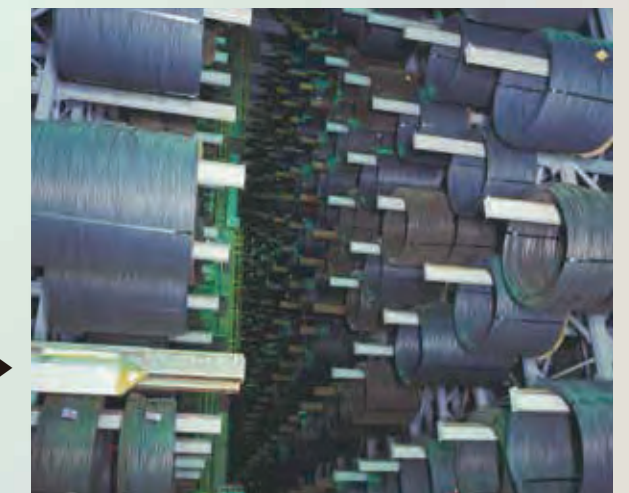
冷却コンベア▶ 冷却速度をコントロールします。 (制御冷却)
