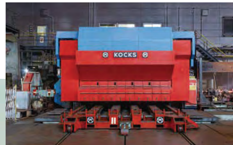
▲仕上圧延機 (ブロックミル) 三方ロール式を採用し、真円度の高い精密圧延を行います。
