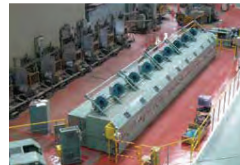
高速連続伸線機
