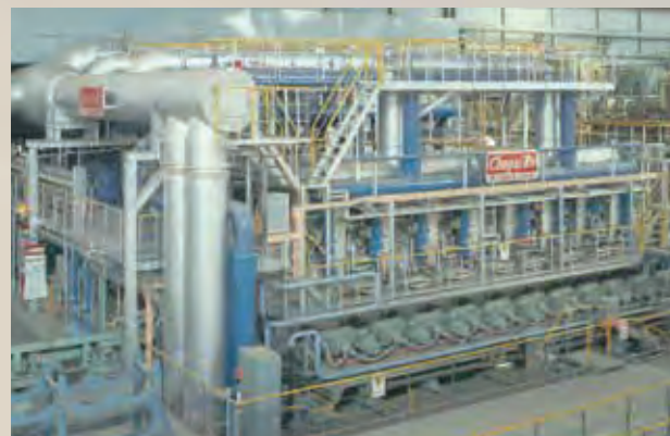
▲加熱炉 ビレットを約1,000℃に過熱します。
