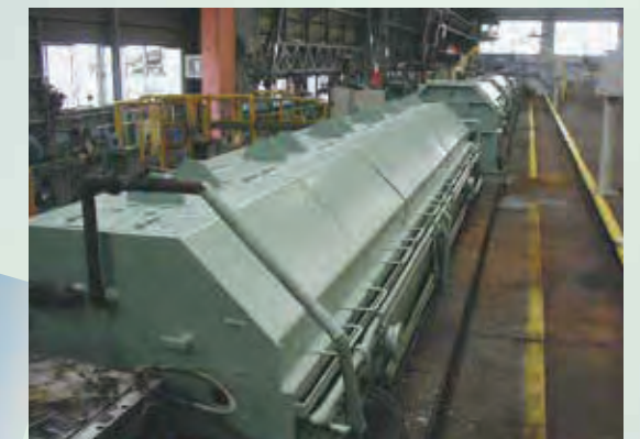
▲製品水冷帯 圧延温度をコントロールします。(制御圧延)
