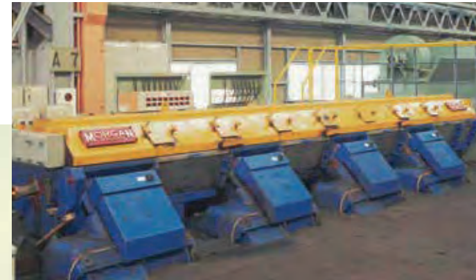
▼仕上圧延機(ブロックミル) 低温圧延が可能な高剛性の圧延機です。(制御圧延)
