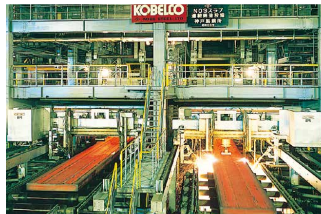
連続铸造設備 (出側)
