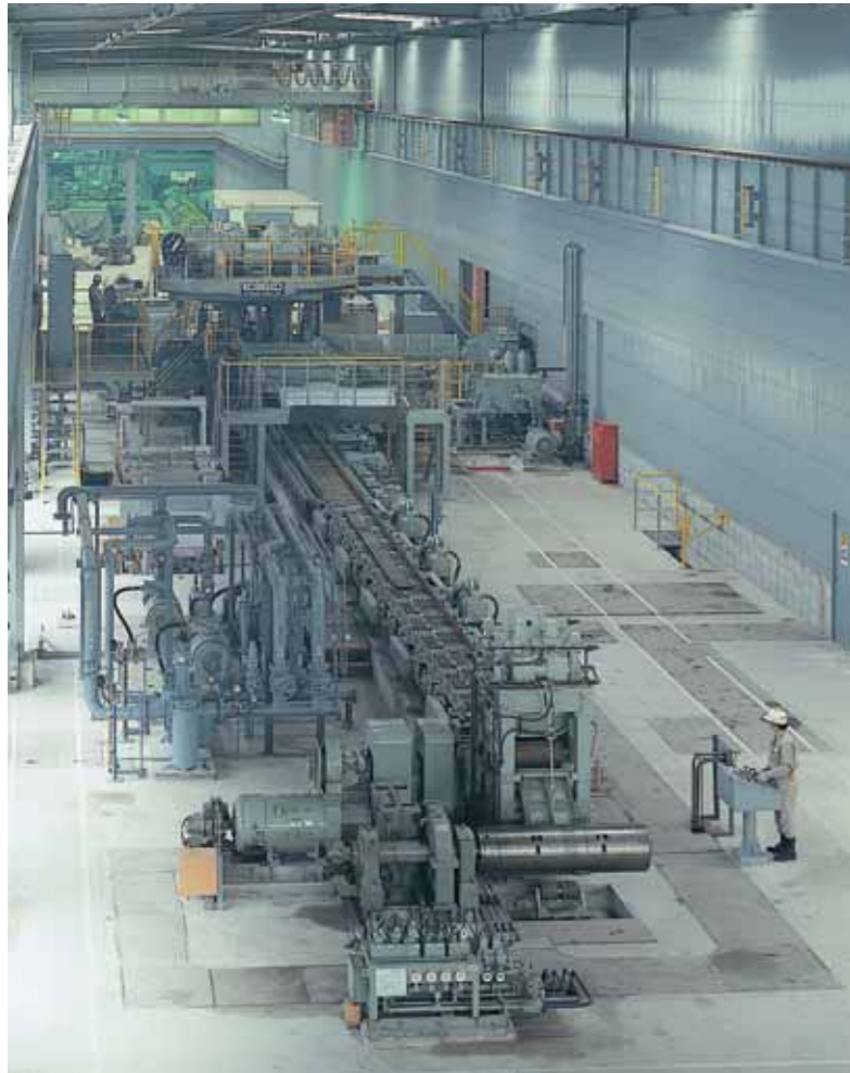
↑実験用熱間圧延設備 厚板、薄板の新製品開発、圧延技術の開発、さらには特殊合金の試作実験など多目的に使用されている。熱間仕上り寸法：最小板厚2mm、最大板幅470mmの鋼板が圧延可能で、厚板や熱延鋼板の制御冷却及び直接焼入処理などのシミュレーション実験が可能である。
