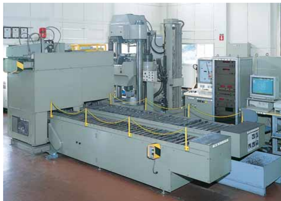
全自動引張試験機 鋼板の仕様、設計基準となる引張特性を求めするための試験機であり、降伏点、引張強さ、伸びなどの特性値が自動的に測定される。
