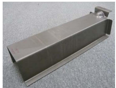
超高加工性980N/mm 2 級材による試作品
