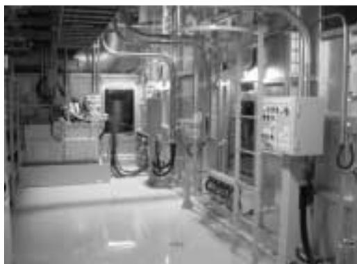
写真2 搬送用チャンバの一例(2次冷却チャンバ)
