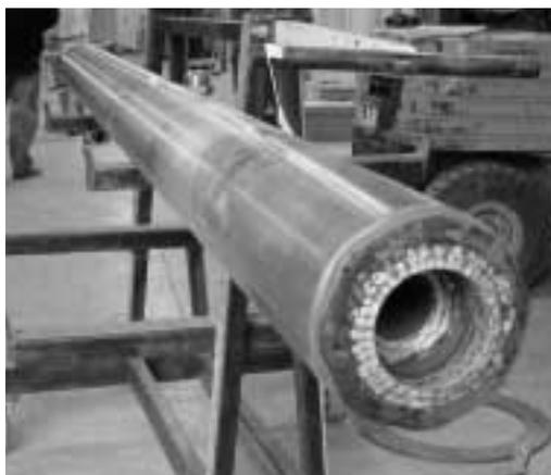
写真1 日本原子力研究所殿向け溶融炉に使用しているPT250型
