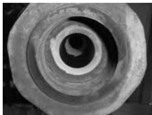
写真4 陰極(前部電極)におけるプラズマアーク痕の付着状況
