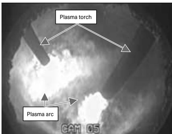
写真5 溶融中の炉内状況（炉内監視カメラからの映像）
