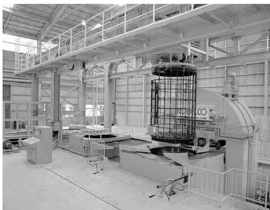
図1 大形CIP装置(200MPa × 2,000 × 3,000mm)
