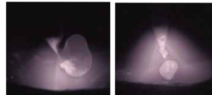
マグ溶接でのソリッドワイヤの溶滴移行 Droplet transfer of solid wire in GMAW welding
