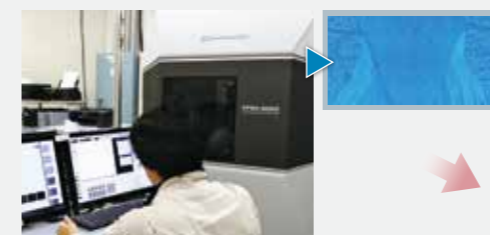
EPMAによる溶接部の元素マッピング(イメージ) EPMA color mapping of specific element (image)
