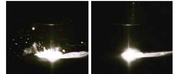
マグ溶接でのソリッドワイヤのスパッタ発生状況 Spatter generation of solid wire in GMAW welding
