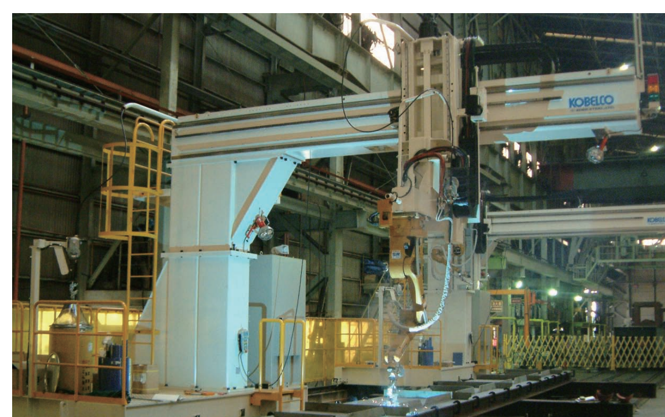
片門型シングルパネル溶接システム Semi-Gantry Type Single Panel Welding System
