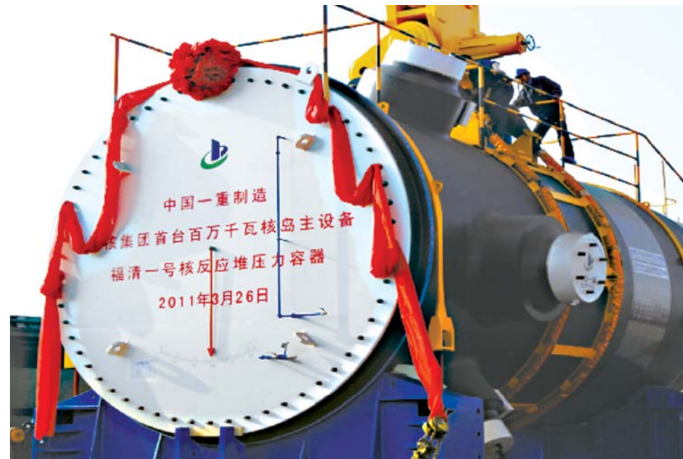
制品外观照片 <反应堆压力容器(RPV), 福清一期, 照片由中国第一重型机械集团公司提供>
