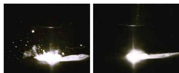
实芯焊丝 MAG 焊中飞溅的发生情况
