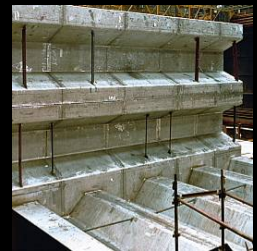
ケミカルタンカー内部 (2相ステンレス鋼)
