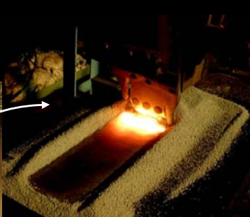
エレクトロスラグ式 帯状電極肉盛溶接法
