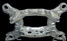
FAMILIARC MIX-1TS による合金化溶融亜鉛めっき鋼板の溶接例
