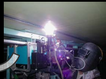
PREMARC TG-S709S を用いたGTAW自動溶接装置「TIL-Automatic」による上向溶接
