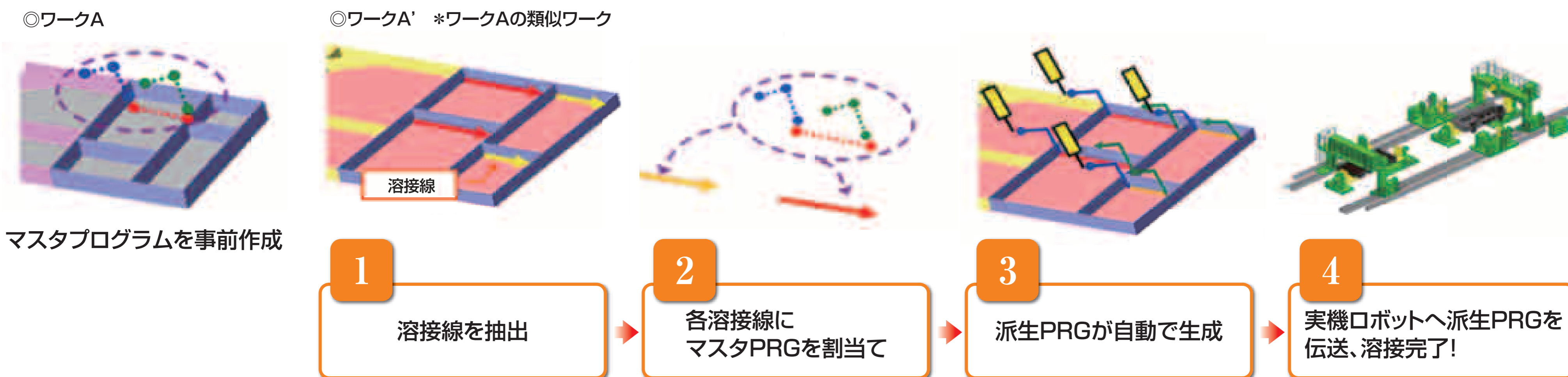
実機ロボットによるティーチングと比較したオフラインティーチング効果例
