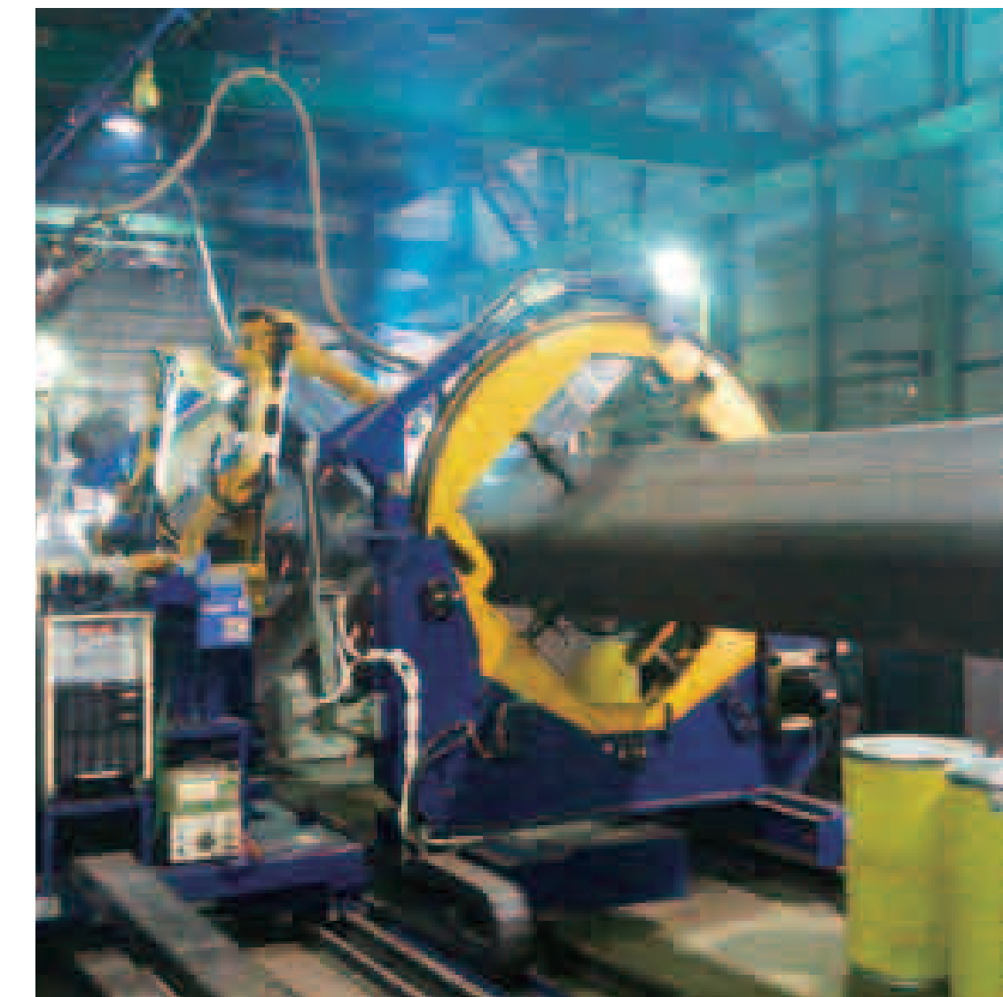
REGARC™ 鉄骨柱大組立 2アーク溶接システム
