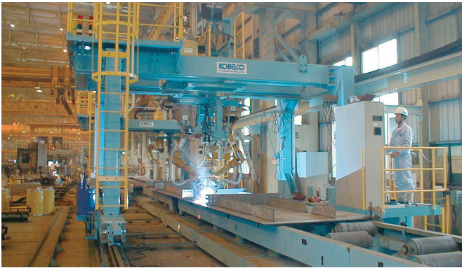
門型ツインパネル溶接システム / Gantry Type Twin-Panel Welding System
