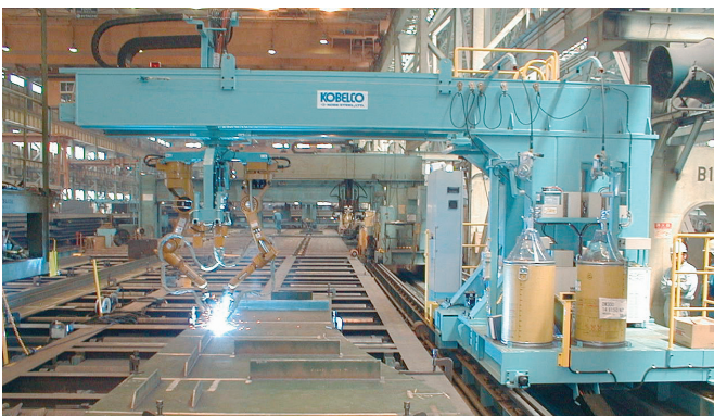
片門型ツインパネル溶接システム / Semi-Gantry Type Twin-Panel Welding System
