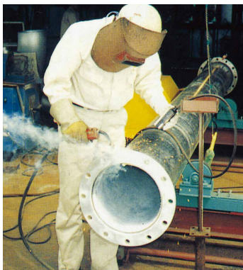
パイプとフランジの適用例 亜鉛めっき鋼板の溶接ではヒュームの発生量が多くなりますので、特に局所排気および全体換気の実施、呼吸用保護具の着用などを徹底してください。
