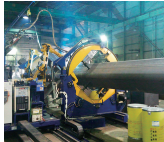
REGARC™ 鉄骨柱大組立 2アーク溶接ロボットシステム
