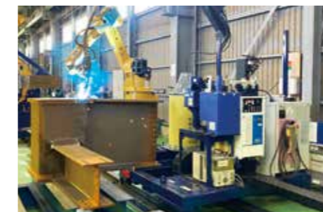
柱大組立溶接ロボットシステムによる仕口溶接
