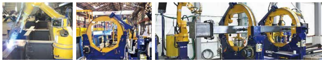
柱大組立システムでの仕口施工例
